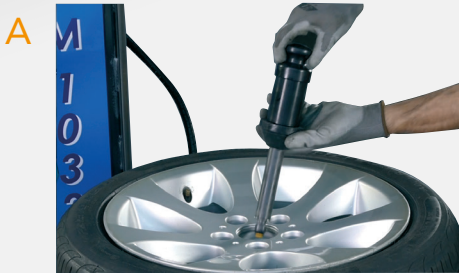
INSERTE LA MANILLA CON CONO DE BLOQUEO
