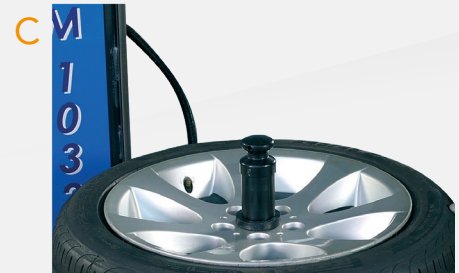
BLOQUEAR LA RUEDA SOLTANDO EL PEDAL
