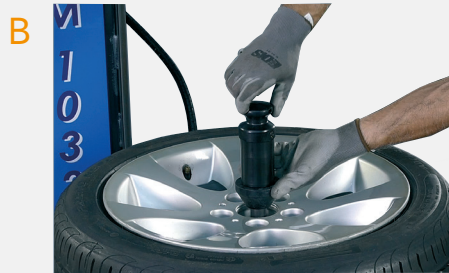
LUGAR LA MANILLA CON CONO EN LA LLANTA
